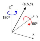
今度は先に z 軸回りに 180 度回転させ,しかる後に y 軸回りに 90 度回転させるという回転を表してみましょう.行列の順序を入れ替えただけです.
