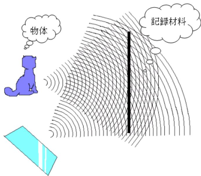
図では、物体からの光(物体上のある一点からの反射光が代表で描かれています)と、ミラーから記録材料に照射する光が干渉する様子が描かれています。また、もっと縞の細かい干渉縞を見ると、面白いものが見えてきます。
