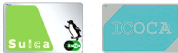
図3 Suica (左) と ICOCA (右) . 中にはコイルと IC チップが入っている .
