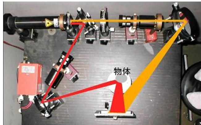
記録に使うのは干渉性のよい，コヒーレントなレーザー光です。このレーザー光を図のように，ビームスプリッターで二手に分け，それぞれを対物レンズで広げます。一つは物体に照射して反射光を生じさせ，ひとつは記憶材料に照射させます<sup>\*1</sup>。すると，二つの光の波は干渉し，記録材料上では干渉縞が発生します。この干渉縞を記録材料に記録すれば，ホログラムの完成です<sup>\*2</sup>。
