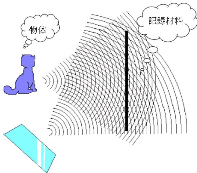
上図では，物体からの光（物体上のある一点からの反射光が代表で描かれています）と，ミラーから記録材料に照射する光が干渉する様子が描かれています。また，もっと縞の細かい干渉縞を見ると，面白いも
