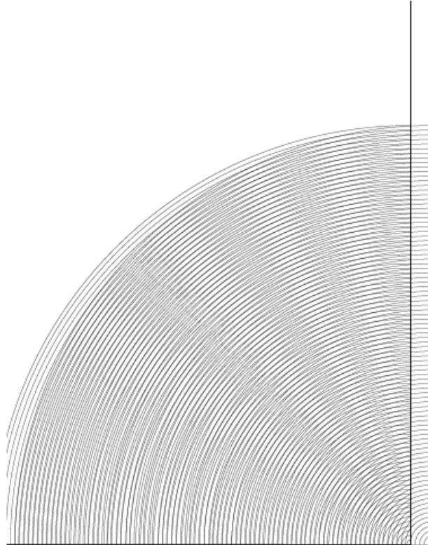
上の図からは、光の波が重なっている部分に、一連の黒い縞のパターンが見受けられます。これは、モアレ縞と呼ばれるもので、これこそが 2 つの点から生じる光によってできる干渉縞に相当します。
