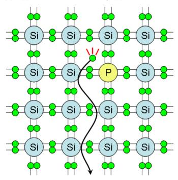
周りの原子との結合に寄与する電子は 4 つであるため,1 つの電子が余ることになります.この余った電子は,弱い力でリン原子に捕まっているので,少しのエネルギーを得て自由になることができます.この電子は自由に動くことができるため,電界を印加すると電界と逆方向へ移動し,電流が流れることになります.このため,真性半導体に比べて抵抗率が低くなります.
