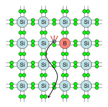
今度は電子が一つ足りないため,電子の座席に一つ穴があくことになります.この穴は中性だったところから電子が一つ抜けた状態であるため,正の電荷を帯びています.この穴へ,ほかの電子が入ると,その電子が元いた位置に穴が移動しているように見えます.これを次々に繰り返していくと,この穴は電界の方向へ移動して行きます.これを,もっとマクロに見ると,まるで正の電荷を持った粒子が移動しているように見えます.この粒子のことを, 正孔 といいます.N 形半導体と同じように,正孔が自由に移動できるため,真性半導体に比べて低い抵抗率を持ちます.
