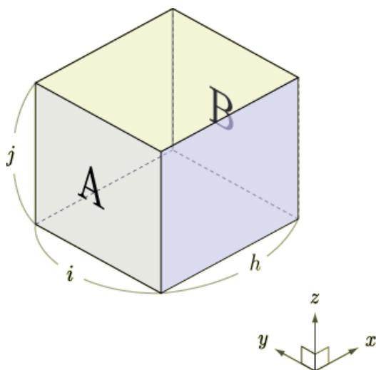
もう一度自分の使い慣れた記号を使って書いてみます. 直方体への, ある面  $A$  からの単位面積あたりの流入量 (例えば温泉のお湯とか) を  $F(x)$  とします. 面  $A$  と平行な面  $B$  までの距離を  $h$ , 長さ  $h$  の辺に平行に  $x$  軸, 同様に  $i$  の辺に平行に  $y$  軸,  $j$  の辺に平行に  $z$  軸をとると, 面  $B$  からの単位面積あたりの流出量は  $F(x+h)$  となります (下図参照).
